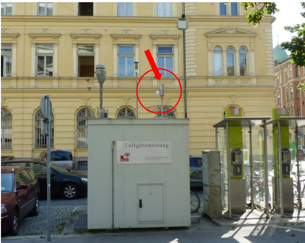
Abbildung 4. Beispiele für typische Messstandorte im Passivsammler-Messnetz. Oben: Messstelle „Dirschbach A12 km 93,3“ als verkehrsnaher Standort; Unten: Referenzmessstelle „Innsbruck/Fallmerayerstraße“, der Pfeil markiert die Anbringung der Passivsammler neben der Ansaugöffnung für die NO 2 -Referenzmessung.
